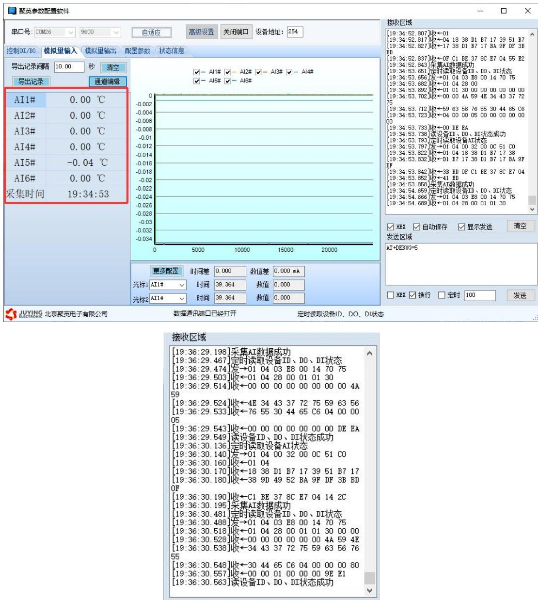
**指令生成说明：**对于下表中没有的指令，用户可以自己根据 Modbus 协议生成，对于继电器线圈的读写，实际就是对 Modbus 寄存器中的线圈寄存器的读写，上文中已经说明了继电器寄存器的地址，用户只需生成对寄存器操作的读写指令即可。例如读或者写继电器 1 的状态，实际上是对继电器 1 对应的线圈寄存器 00001 的读写操作。
